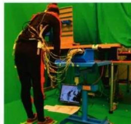
Afbeelding 3. Testopstelling, op het scherm is de output van de Ergomix te zien, gebruikt als middel om de romphoek te controleren. Foto: Tim Bosch.
