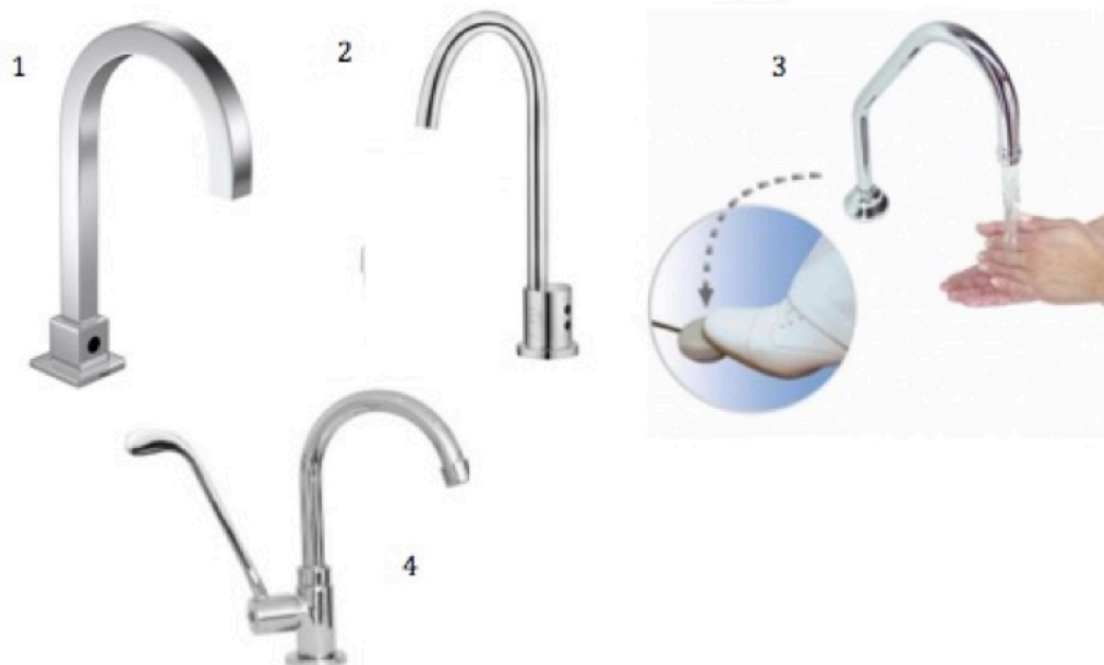
Figura 18: tipos de torneiras utilizadas em laboratório. (1) torneira com sensor de presença; (2) torneira com sensor tipo on/off (aciona para ligar e aciona novamente para desligar) ; (3) torneira com acionamento pelo pé e (4) torneira com acionamento com o cotovelo
