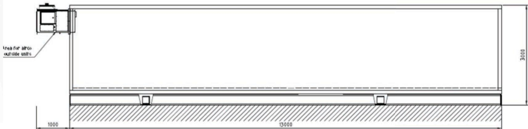
Detalhes do trailer: L: 13 (14), W: 3,5 H: 3. 39,000 KG. Paredes tipo sandwich não corrosivas. 3mm led.
